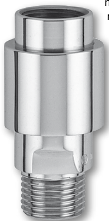
Rohrunterbrecher Typ DC eignen sich nach Norm für die Absicherung bis Flüssigkeitskategorie 5, soweit ein Rückdrücken ausgeschlossen werden kann
